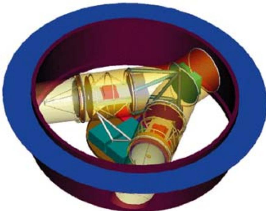
**Bild 15 zeigt einen der drei LISA-Satelliten.** Diese bestehen aus einem gleichseitigen Y, in dessen beiden Armen je ein Teleskop mit seinen Testmassen und je ein Laser-Sender- und -Empfänger untergebracht sind. Im unteren Teil des Y befinden sich die Bordelektronik, die Stromversorgung und die Telemetrieelektronik.
